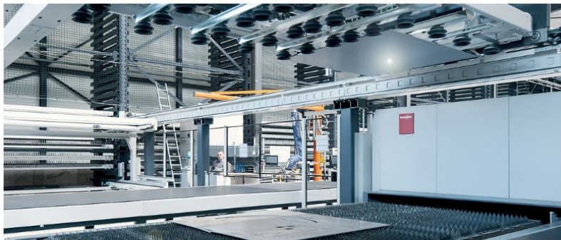
Beim Absortieren großer Blechschnitte werden nur bestimmte Sauger der Beladeinheit angesteuert. © Remmert
