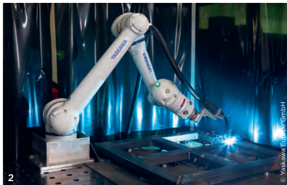
1 Die Cobot-Schweißzelle Weld4Me von Yaskawa verbindet in kompakter Form die Vorteile eines kollaborativen, einfach bedienbaren Roboters mit professionellen Schweißfunktionen. 2 Der Cobot HC10DT IP67 ist in Schutzklasse IP67 ausgeführt und somit vor Schweißspritzern im Produktionsprozess geschützt.
