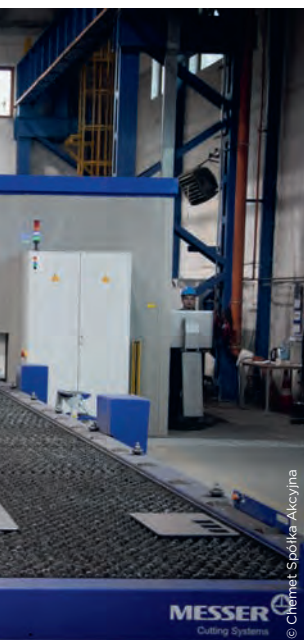
1 Die Lasermaschine PowerBlade mit 6-kW-Fasenschneidkopf und OmniScript-Nadelmarkierer
