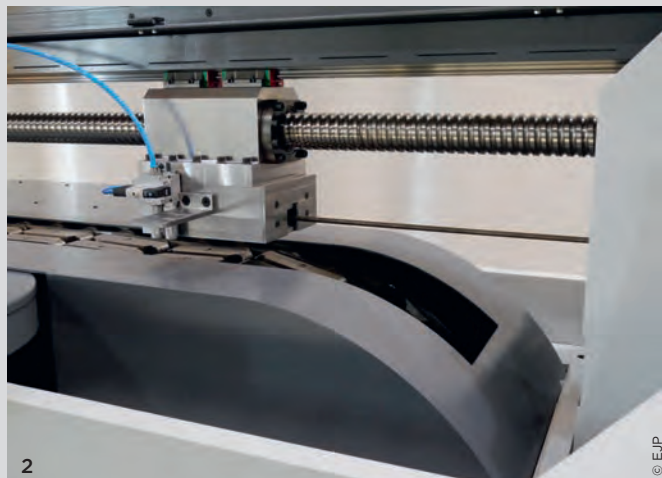
1 Eine auf einer Kugelumlaufspindel montierte Einziehzange fördert einen neuen Draht in die Maschine, der anschließend vom Raupenzug gefasst wird
