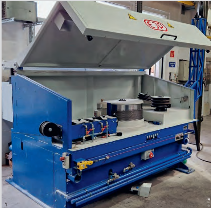
1 Eine auf einer Kugelumlaufspindel montierte Einziehzange fördert einen neuen Draht in die Maschine, der anschließend vom Raupenzug gefasst wird
