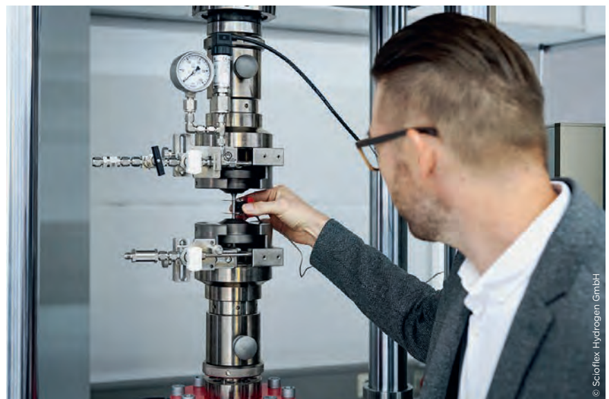
Für Dr. Bernd Schrittmesser, Geschäftsführer Scioflex Hydrogen GmbH, eröffnen ZwickRoell-Prüfsysteme ein komplett neues Feld der Materialcharakterisierung unter Einfluss von Wasserstoff.
