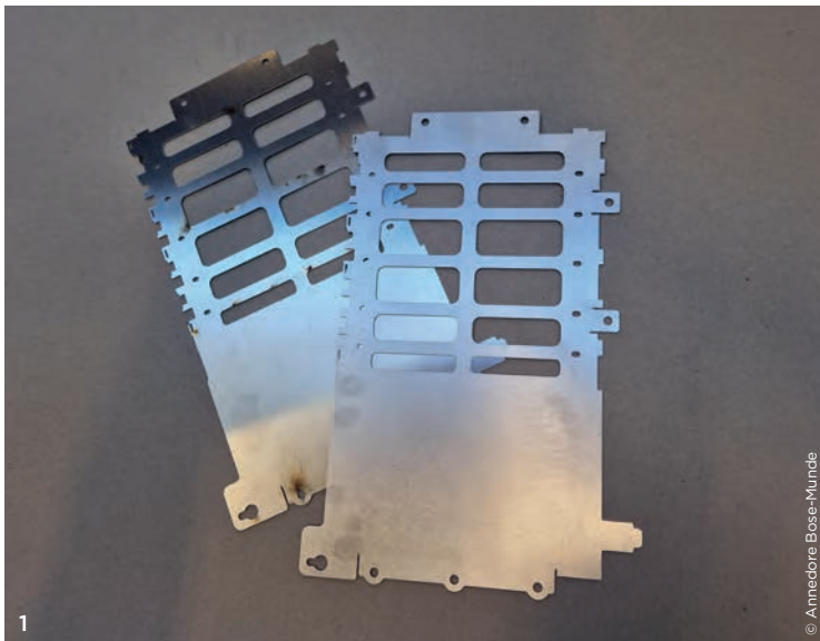
1 Laserbearbeitete Teile (links) werden in der Regel nachbearbeitet. Kunden erwarten, dass die Teile entgratet und somit handfreundlich sind (rechts). 2 Für Marcel Born, Geschäftsführer der Fritz Born AG (links) und Bertrand Laroche, Gebietsverkaufsleiter Metal Processing bei der Lissmac Maschinenbau GmbH, ist das erste gemeinsame Projekt sehr gut gelaufen: Die neue Lissmac-Technik läuft verlässlich und Kunde Born ist zufrieden.
