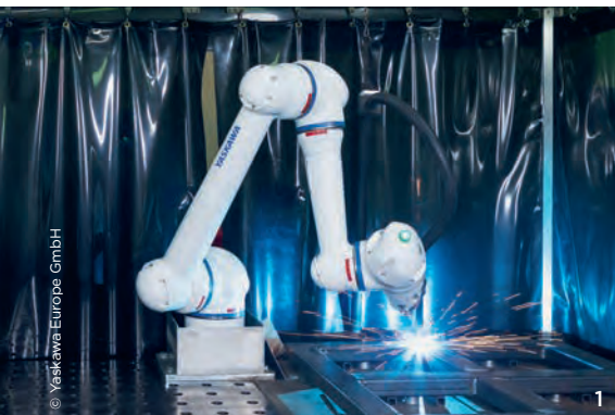
1 Die Cobot-Schweißzelle Weld4Me von Yaskawa verbindet in kompakter Form die Vorteile eines kollaborativen, einfach bedienbaren Roboters mit professionellen Schweißfunktionen. 2 Der Cobot HC10DT IP67 ist in Schutzklasse IP67 ausgeführt und somit vor Schweißspritzern im Produktionsprozess geschützt.
