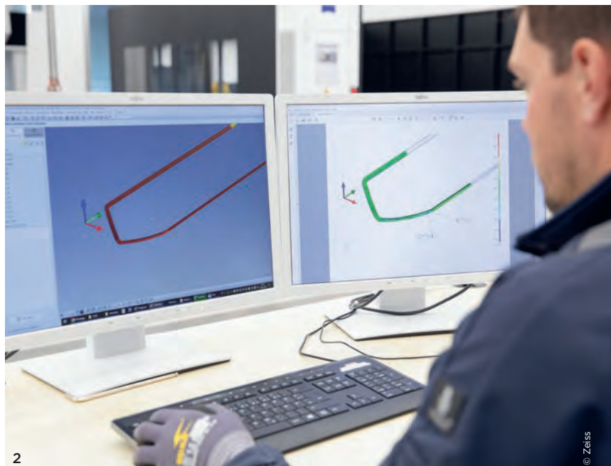
4 Kompromisslose Qualität steht bei Grob an oberster Stelle. Hier ein Stator auf dem Koordinatenmessgerät von Zeiss.
