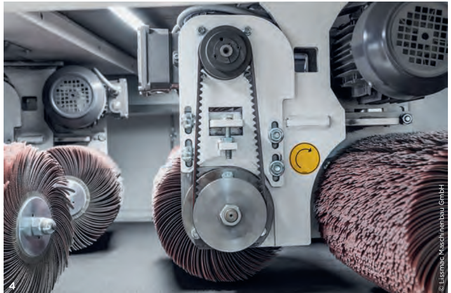
3 Für die Maschinenbediener Peter Loosli (links) und Vinko Prugovecki ist die Arbeit einfacher geworden. Die SMD 335 REE funktioniert verlässlich und die Qualität der Teile stimmt. 4 Dank mehrerer Rundbürsten ist ein richtungsloses Oberflächenfinish möglich.
