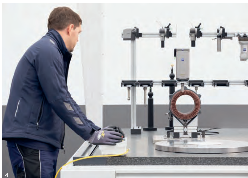
4 Kompromisslose Qualität steht bei Grob an oberster Stelle. Hier ein Stator auf dem Koordinatenmessgerät von Zeiss.
