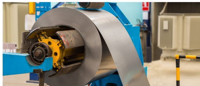
Das Elektroband muss nach dem Abwickeln zunächst gereinigt werden. © teptong - stock.adobe.com
